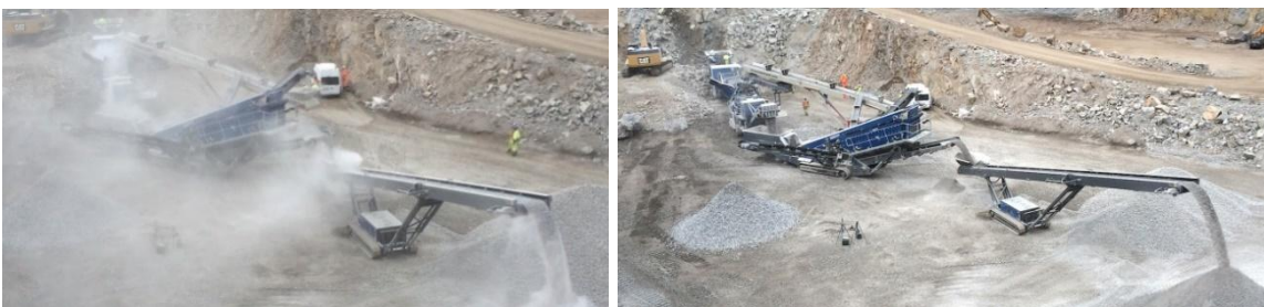
Abbildung 5-1: Einfluss von Befeuchtungsmaßnahmen an einer Aufbereitungsanlage. Links: Ohne Befeuchtung. Rechts: Mit Befeuchtung. Fotos: Klenk et al. (2016).
